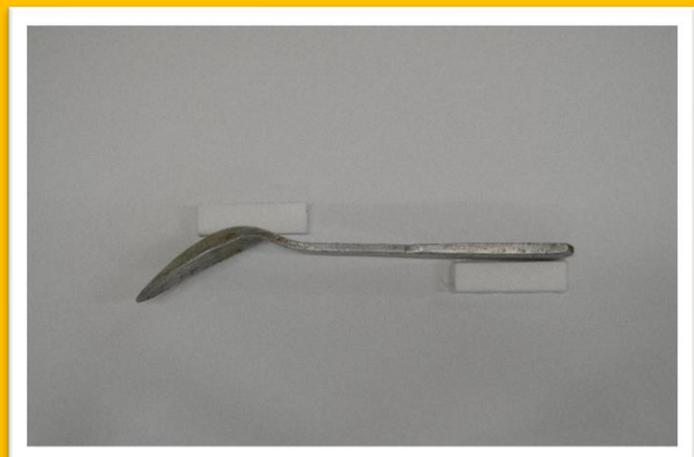
日干しレンガを削って型をつくり、溶接用のアルミを溶かしてレンガの型に流し込んだものを金槌で叩いて形を整え、ヤスリで仕上げました。
